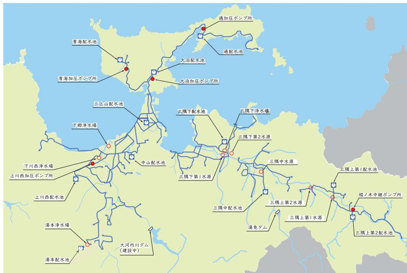
図6 長門・三隅地区の水道施設の配置※1
