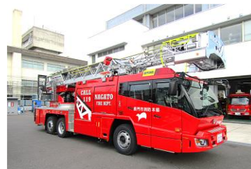
30m級先端屈折式はしご付消防自動車
