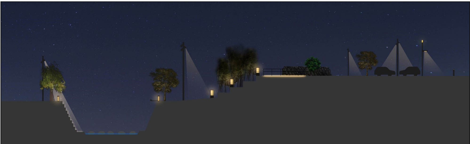
深夜は、調光タイプの照明で約10%点灯。安心安全に通行できる必要最低限の明るさを確保。
