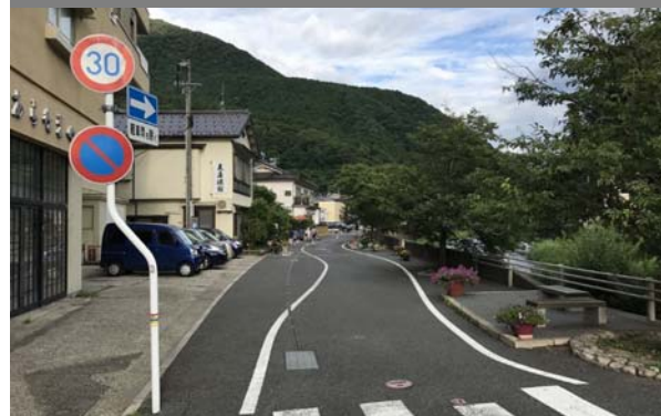
▼一方通行・30km/h規制・駐車禁止による自動車交通制御
